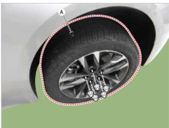
拆卸车轮和轮胎(A)时小心不要损坏轮毂固定螺栓。
