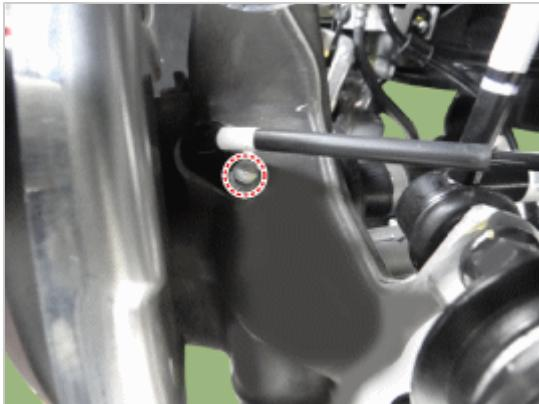
5. 分离ECS传感器连接器(A)，并拆卸支架(B)。
